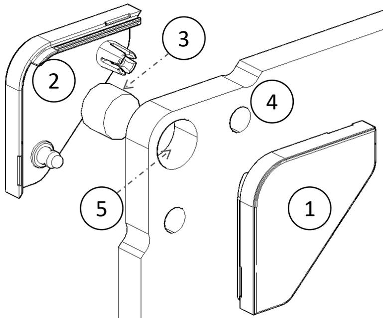
Durch die Kunststoffecken ergibt sich ein weiterer Vorteil: Bei Beschädigung oder eingeschränkter Funktion des Magneten kann jede Ecke unabhängig von den anderen gewechselt werden. Somit muss nicht die ganze Diskette ausgetauscht werden.
